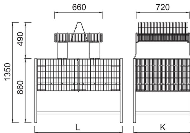
комплектуется делителем и двумя полками
