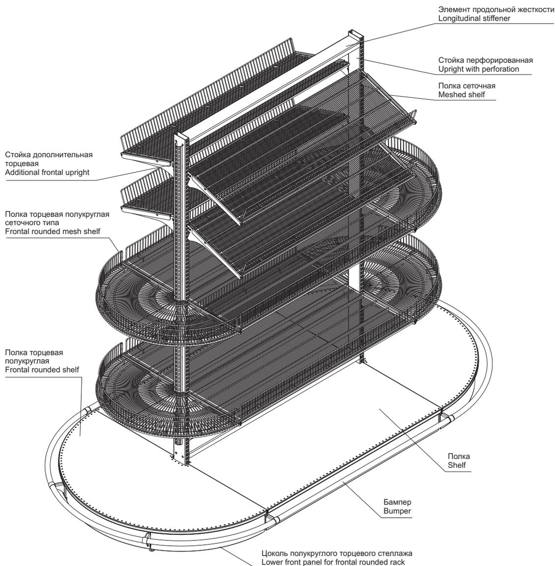
Схема сборки сеточного стеллажа
