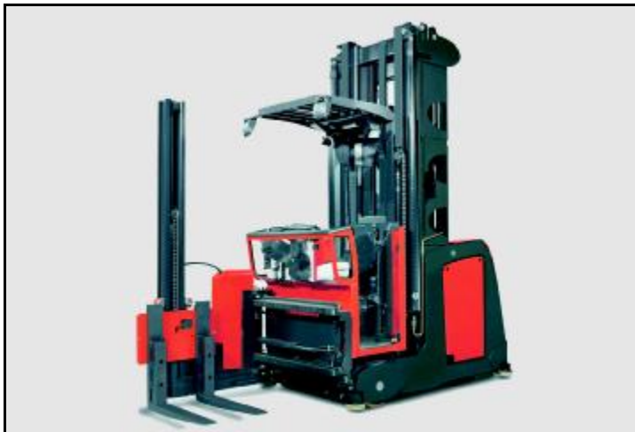
Погрузчик башенный с внутренней кабиной
